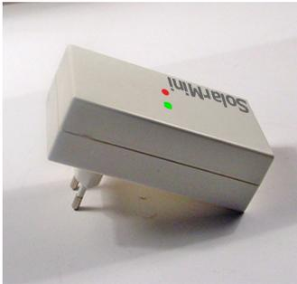
SolarMini es un termostato diferencial para la regulación de instalaciones solares formadas por panel solar y acumulador con circulación forzada o en instalaciones con energía solar distribuida.
